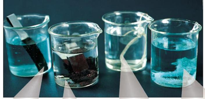
Alambre de cobre en disolución acuosa de AgNO<sub>3</sub>
